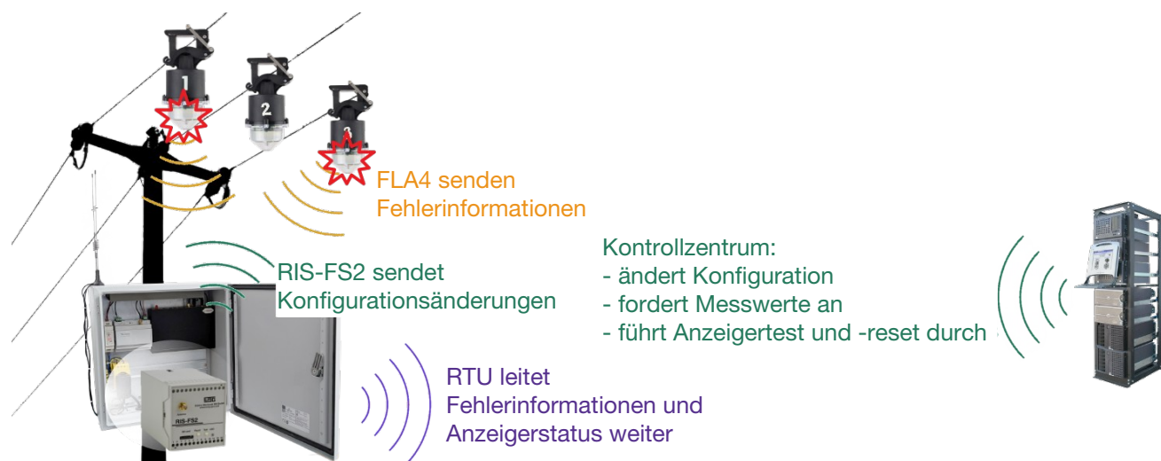
Abbildung 3: Installationsszenario mit Freileitungsanzeigern Typ FLA4
